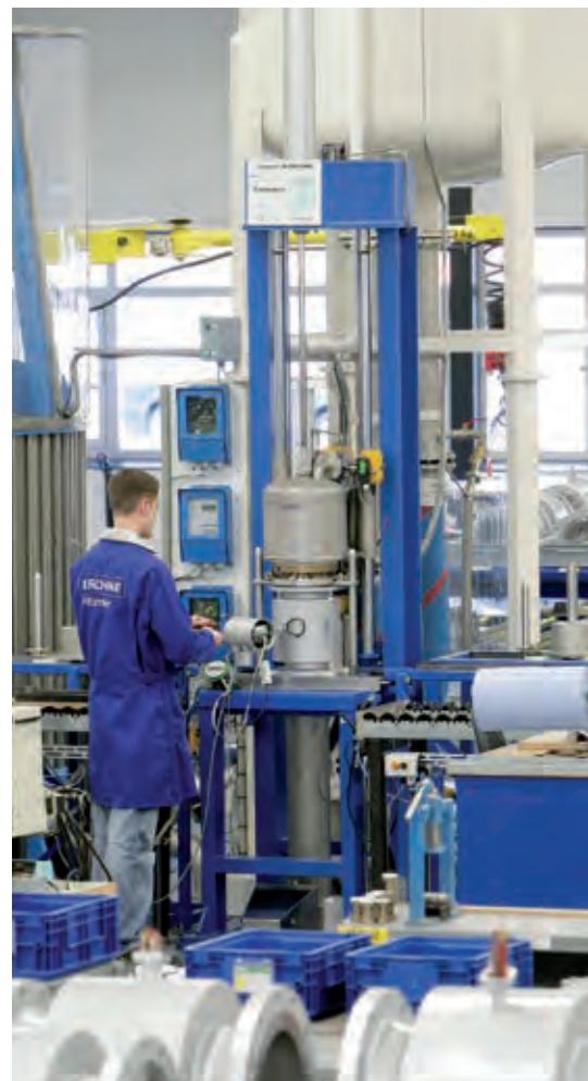
Calibrador de pistón volumétrico
