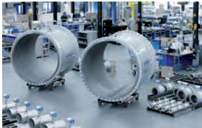
Producción de caudalímetros ultrasónicos en Dordrecht, Países Bajos
