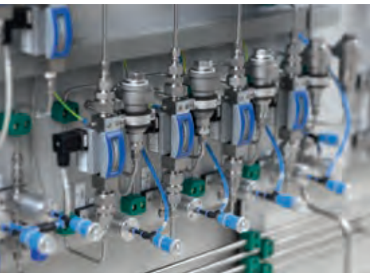
Inertización con rotámetros de purga
