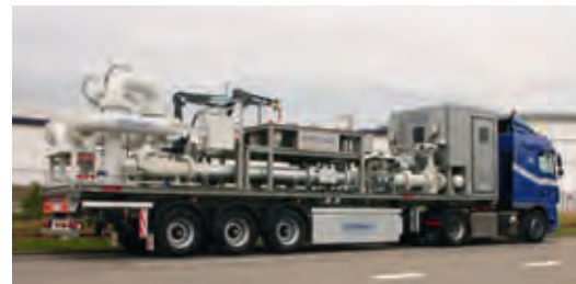
Sistema de medida con caudalímetro maestro móvil
