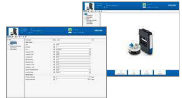
Configuración del transmisor de temperatura OPTITEMP TT 51 mediante PACTware™
