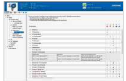
Configuración del transmisor de temperatura OPTITEMP TT 51 mediante PACTware™
